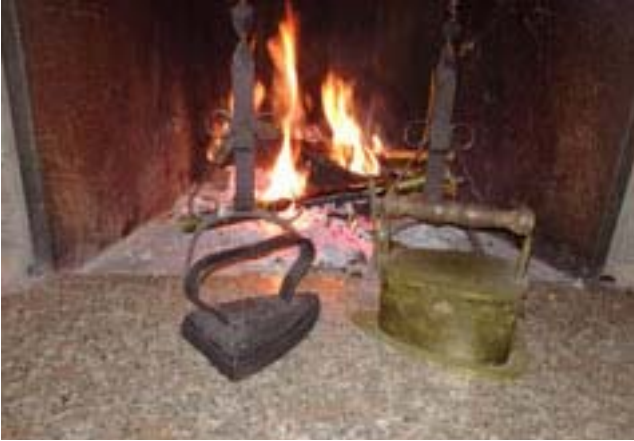
A dx ferro per brace, a sx, ferro da scaldare su stufa.
